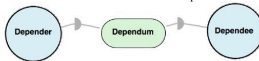
Figura 2: Análise realizada em um modelo SD apresentando os atores dependor e dependee , e o elemento intencional do dependum
